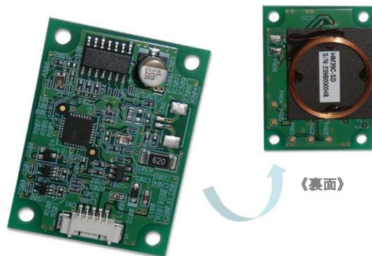
HMシリーズは、NXP製LF帯(125kHz帯)HITAG対応IC/HTRC110搭載のリーダライタモジュールです。
