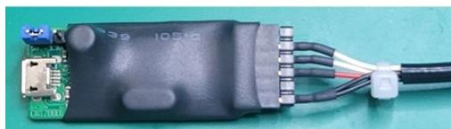
誤挿入防止用に未使用ピンを埋めてあります。ずれのないようにコネクタを挿入します。
